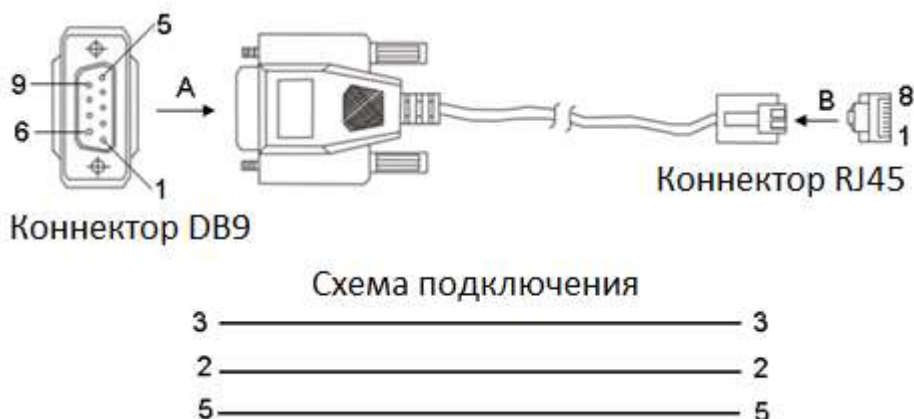
Рис. 18. Схема подключения консольного кабеля
