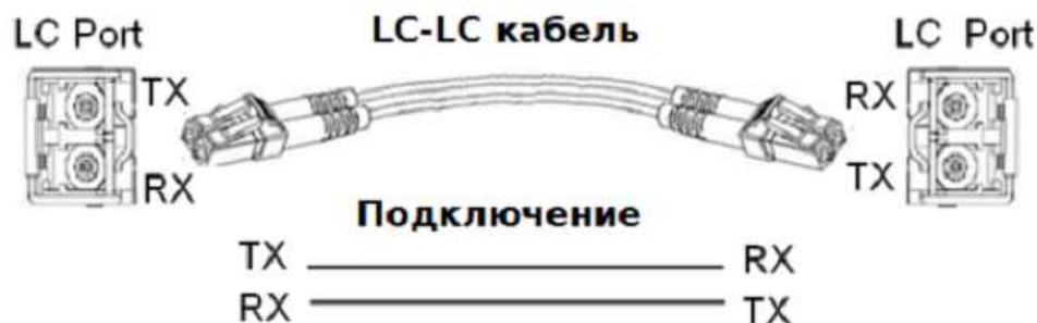
Рис. 15. Подключение оптического кабеля
